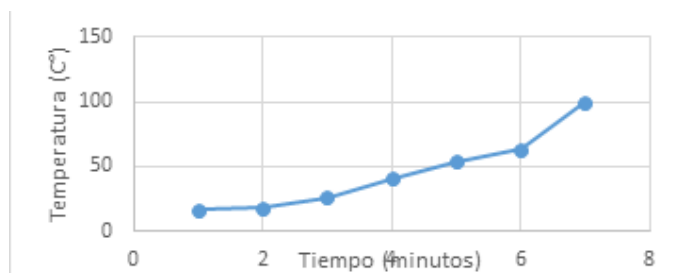
Figura 3. Tiempo que tarda la muestra de aserrín en alcanzar los 100°C.
