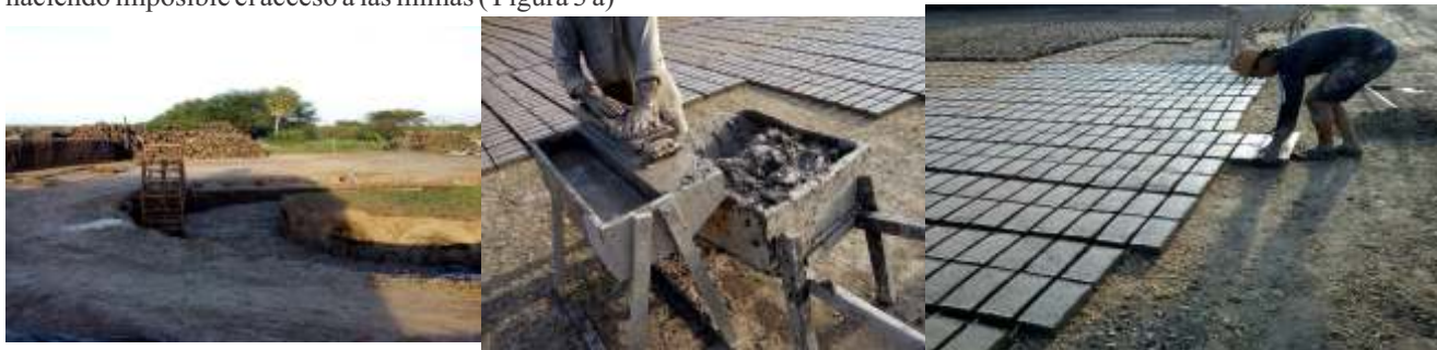
Figura 2. a) Pisadero donde se realiza la mezcla, b) Moldeado manual, c) Secado
