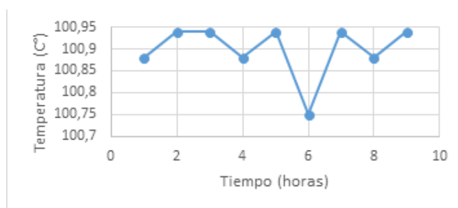
Figura 4. Temperatura de la muestra de aserrín registrada en intervalos de 1 hora.
