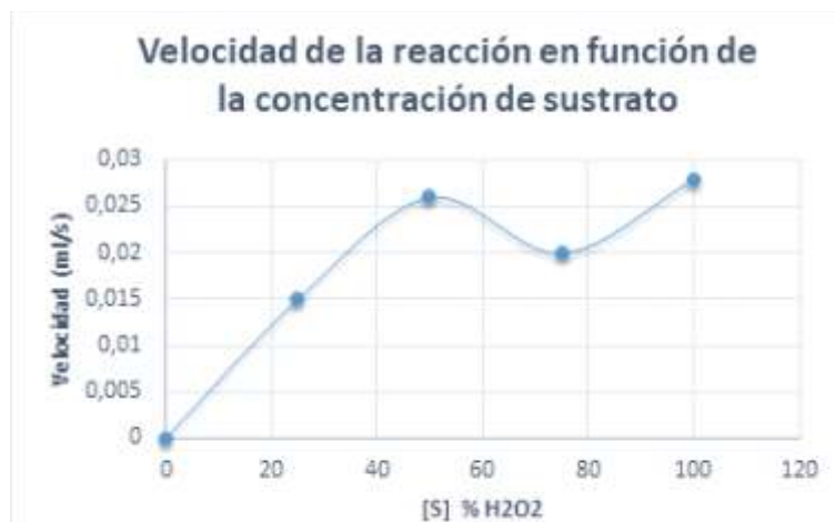
Figura 2: Gráfico de la velocidad de reacción del peróxido de hidrógeno, catalizada por la enzima catalasa, en función de la concentración de sustrato. Los datos utilizados en este gráfico son los obtenidos a partir de la experiencia.
